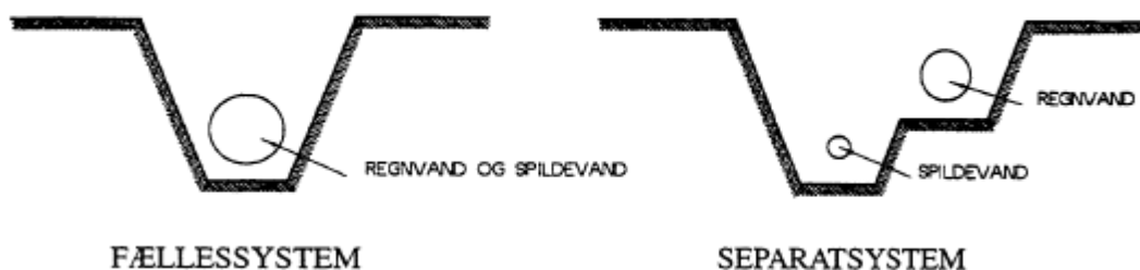
Figur 2 viser princippet i fælles -og separatsystem
